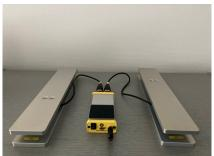
Bei einem Gewichtsverlust grösser als 750 Gramm wird ein "Schwarmalarm" per SMS versendet (falls aktiviert; es wird das aktuelle Gewicht mit dem Maximalwert der vorherigen 5 Messungen verglichen).
